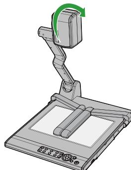
步骤 3: 轻压镜头支杆使其倒向工作台面。
