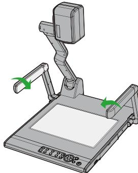
步骤 2: 小心地把镜头从上向内方向旋转到镜头朝外位置，盖上保护盖。
